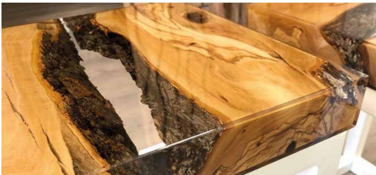
**Sistema epossidico per colate di superficie. Spessore: 2- 4 mm**
